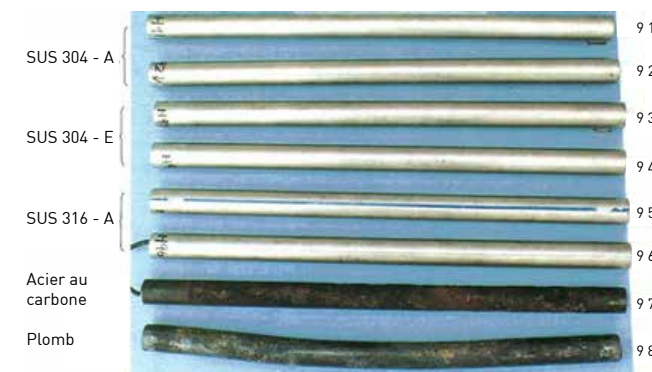
1 . Ville de Kushiro, essai n°H, après décapage à l'acide
