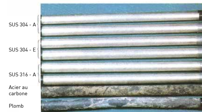
2 . Ville de Kuwana, essai n°P, après décapage à l'acide
